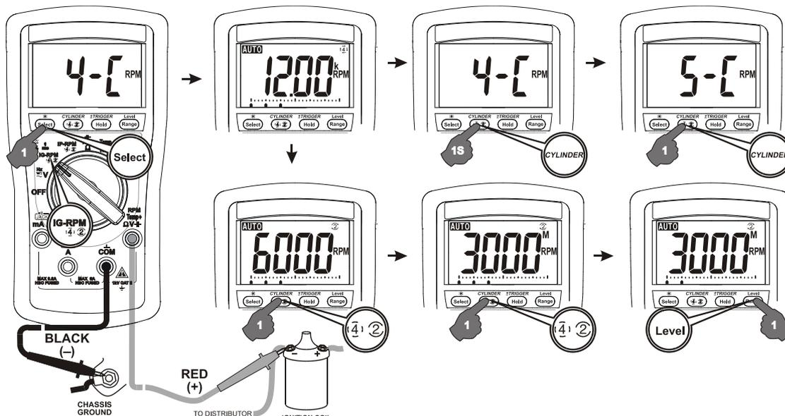
Tryck på (4), (2) knappen kort för att välja mellan **RPM (4)** för 4-takt, **RPM (2)** för 2-takt och DIS, samt **RPM (2) M** för special 2-takts waste ignition engine
