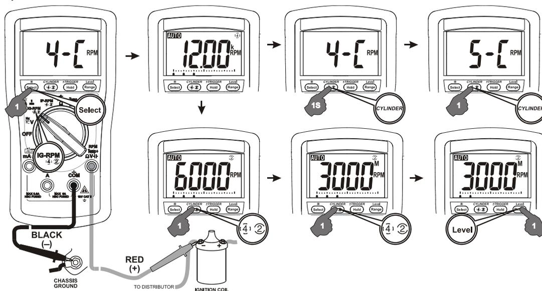
Tryk på <sup>(4)</sup><sup>(2)</sup> knappen flere gange for at vælge RPM<sup>(4)</sup> for 4-takt, RPM<sup>(2)</sup> for 2-takt og DIS og RPM<sup>(2)</sup> M for special 2-takts "waste ignition engine".
